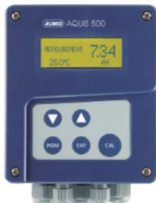
Este dispositivo controla sensores que emiten una señal estándar. La pantalla gráfica permite la visualización numérica de señales estándar o bien como un gráfico de barras. 2 contactos de conmutación de relé implementan funciones de conmutación y alarma, así como tareas de control con comportamiento P, PI, PD y PID. Su estructura permite adaptarse fácilmente a instalación en superficie o en armario de control. Hasta dos salidas analógicas y hasta 2 relés.
