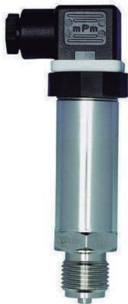
Los transmisores de presión se utilizan para medir las presiones relativas (manométricas) y absolutas en líquidos o gases. El dispositivo de medición para el transmisor es un elemento piezorresistivo o una película delgada galga extensométrica. La presión se convierte en una señal eléctrica.
