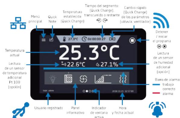
La pantalla táctil del controlador Smart PRO puede ser operada con guantes de látex.
