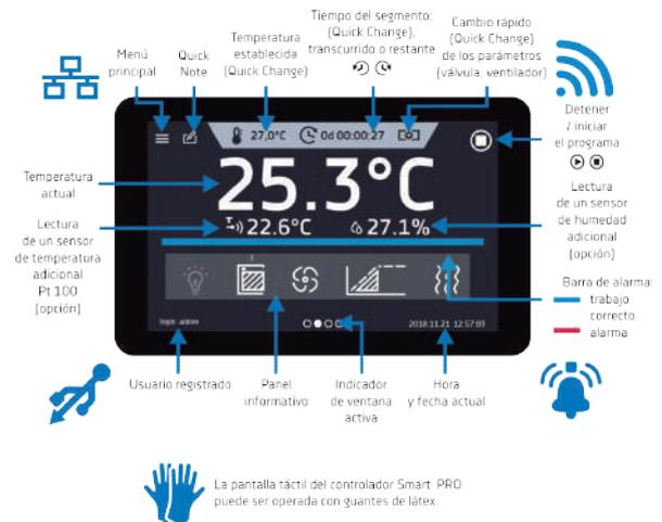
Los controladores Smart y Smart PRO están equipados con una pantalla de un ángulo de visión amplio. Gracias a esto, la imagen en la pantalla es visible desde cualquier ángulo de visión, independientemente de la intensidad de la luz.
