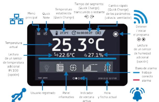
La pantalla táctil del controlador Smart PRO puede ser operada con guantes de látex.
